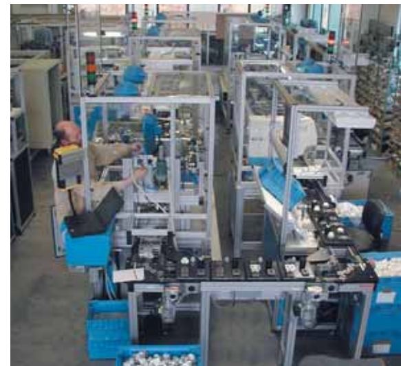
Montageanlage Impulsschalter – 10 Stationen über Transfersystem verkettet
