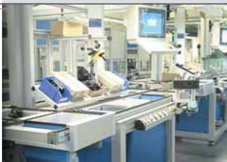
Teilautomatisches Montagebandsystem für Fahrzeugkompressor-Varianten zur Montage und Prüfung mit Prozessdatenerfassung
