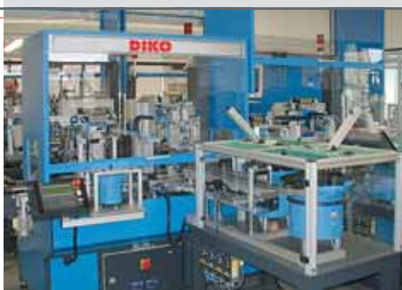
Montage- und Prüflinie für Tankverschlussvarianten mit Entlüftung
