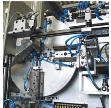
Sonderanlage zur Bestückung von Werkzeugkerneinsätzen mit Kontaktelementen und automatischem Kerneinzug in das Kunststoffspritzwerkzeug
