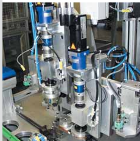
Vollautomatische Prüfanlage für Lichtschienenadapter mit Drehwinkel- / Kraft- / Hochspannungs- / Widerstandsmessung
