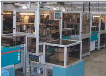
Montageanlage für Funktionsträger BMW auf Bosch MTS 2 Basis: 2 Varianten Funktionsträger und Variante Ablagefach werden im flexiblen Wechsel montiert
