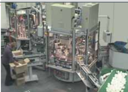
Verkettete Rundschaltisch-Montagen von Cremetiegeln mit hochglänzenden Oberflächen und Schriftzugorientierung
