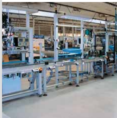
Schwerlasttransfer zur Montage von Kolbenkompressoren
