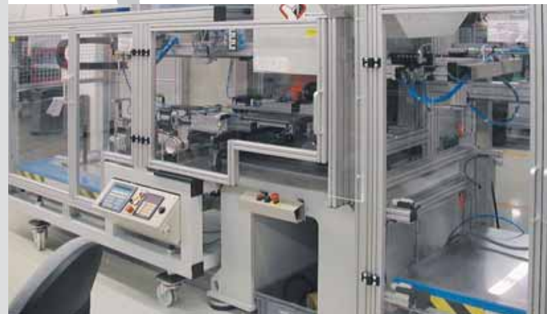
Automatisches Zuführen und lasergesteuertes Positionieren von Folienbögen mit Stanzeinheiten und Abstapelmagazinen
